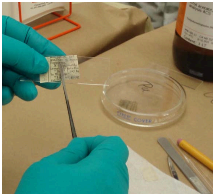
Figure 4. Enlèvement au moyen d'un solvant de rubans fixés sur du papier Punch. Il convient de remarquer l'échantillon se trouvant dans la boîte de Pétri, qui est toujours immergé dans le solvant, en attendant d'être raturé.
